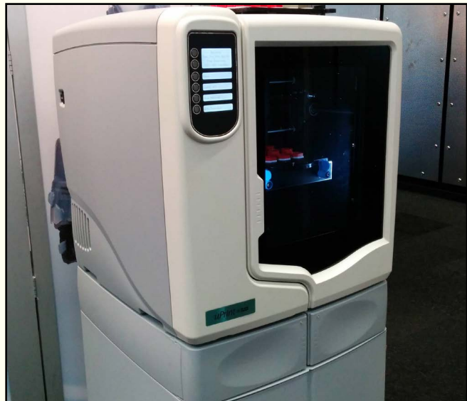
Stratasys uPrint использует термокамеру.
